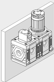
**Befestigung an einer Schalttafel**
