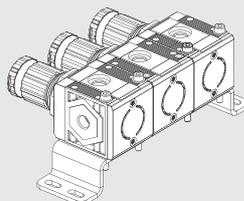
**Befestigung an Schiene nach DIN EN50022 mit 2 Stück Adaptoren**
