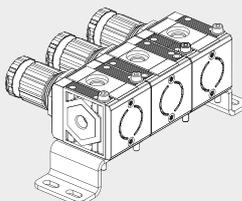
**Befestigung an Schiene nach DIN EN50022 mit 2 Stück Adaptern**
