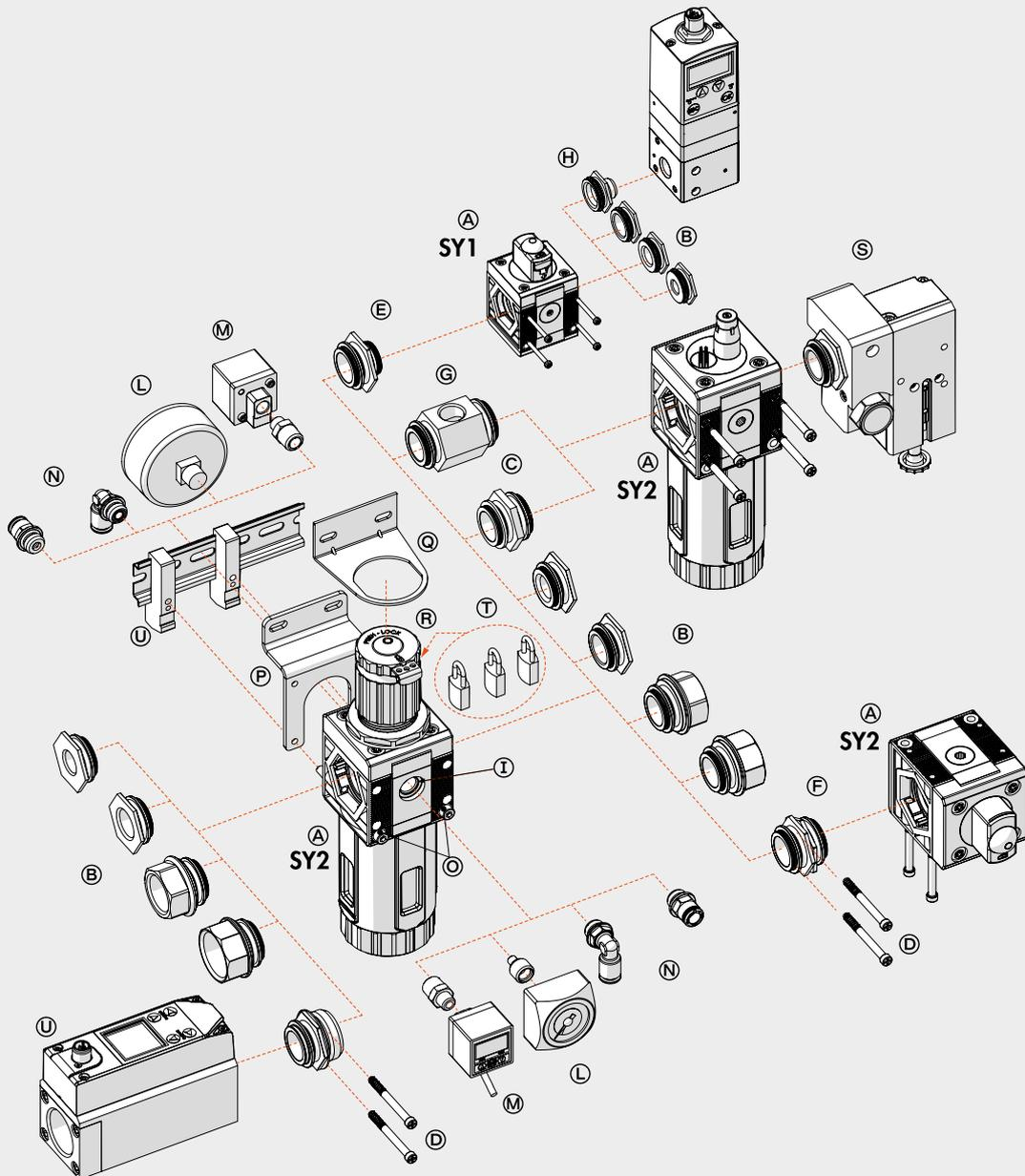
Die verschiedenen Elemente Syntesi® A können miteinander und mit der Druckluftquelle durch die Buchsen B aus vernickeltem Messing oder bei Verwendung der eloxierten Aluminium-Nippel C verbunden werden.
