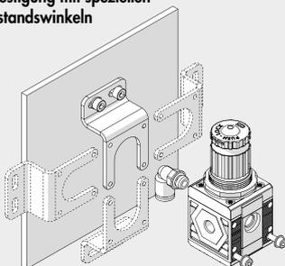
Der Winkel kann in beliebiger Position montiert werden. Die Verschraubungen können dann am Manometeranschluss hinten angebracht werden.
